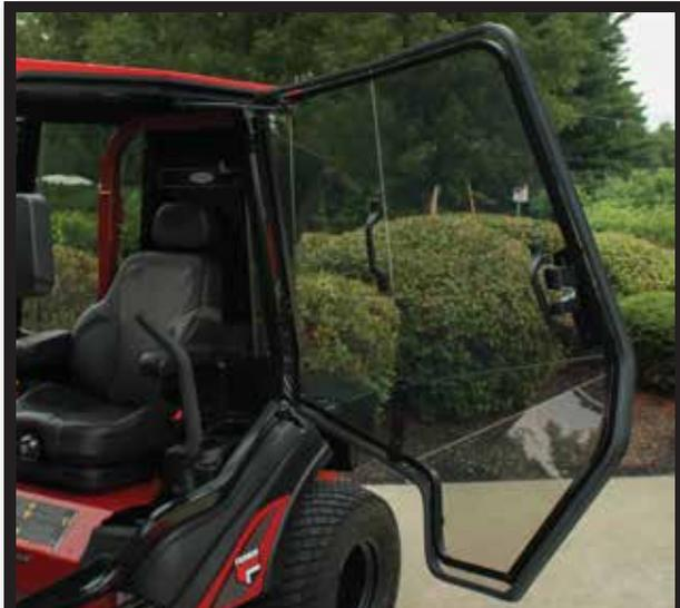
**Entrada sin esfuerzo con puertas laterales grandes, con bisagras traseras y bloqueables que se pueden quitar rápidamente.**
