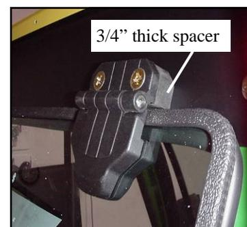
Fig. 6.1.1 Install Spacer Block
