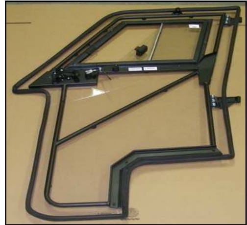
Right Front Door Assembly p/n: 8SV-4810-07R
