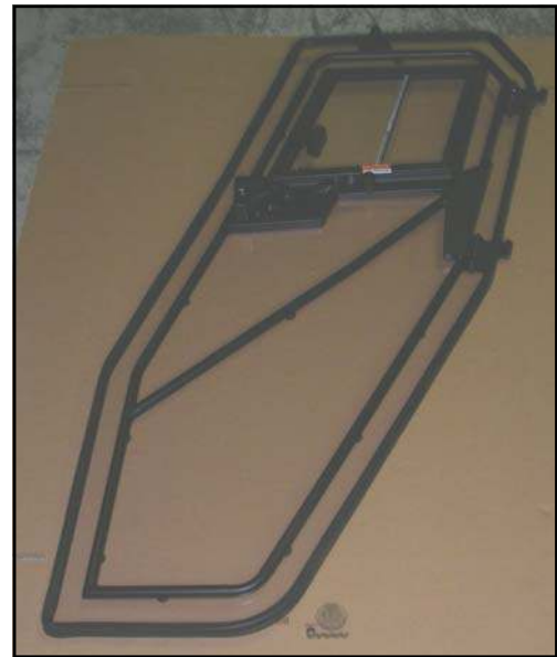
Right Rear Door Assembly p/n: 8SV-5810-07R-R
