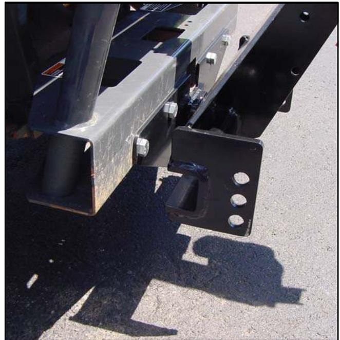
Fig. 11.1—Disposition du cadre de levage et du récepteur
