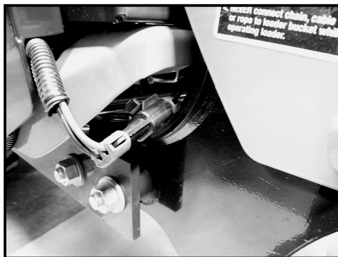
Figure 46 : Raccordement du connecteur étanche
