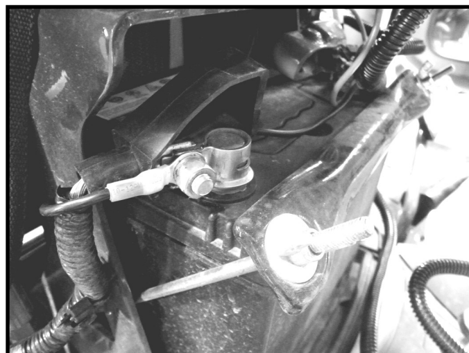
Figure 16 : Installation du fil noir
