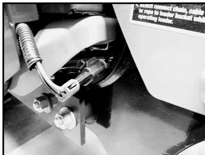
Figure 34 : Connectez le connecteur résistant aux intempéries
