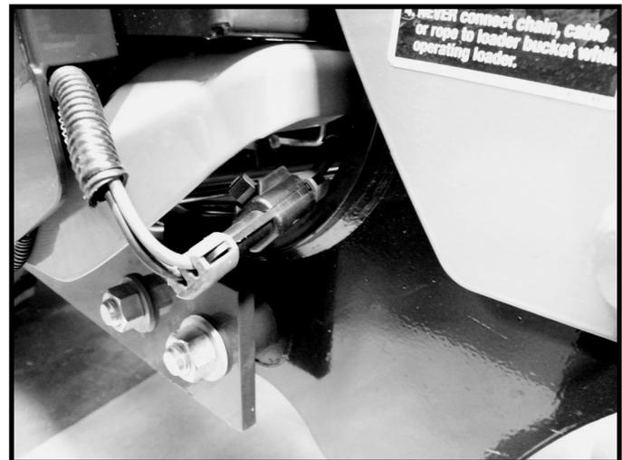
Figure 46 : Raccord du connecteur étanche
