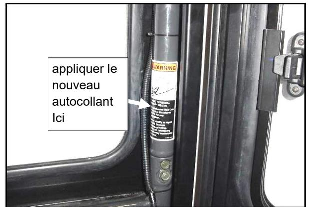
Fig. 6.3 (vue du tube ROPS arrière latéral du conducteur)
