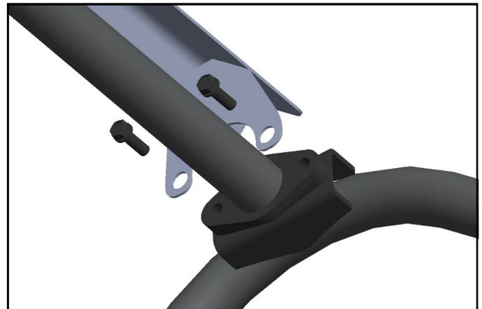
Fig. 2 (installer un support de toit arrière)
