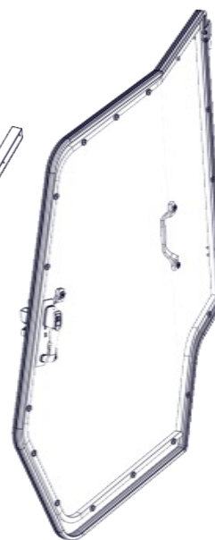
DOOR ASSEMBLY, LEFT P/N: 8SV-107-00060-L
