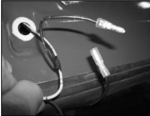
Figure. 4. Retirer le bouchon de caoutchouc de la cabine , et sortir le faisceau de fils tout le chemin révélant le fils BLEU et NOIR .
