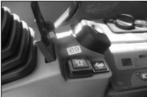
Figure. 10. Afin d'assurer une installation correcte avant de cacher des fils : Connectez la borne (-) de la batterie, mettez le contact à l' accessoire ou START , et appuyer sur le bouton de la lumière stroboscopique ; La lumière stroboscopique allumer.
