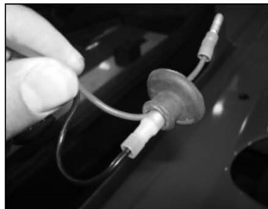
Figure. 7. Insérez les fils noir et bleu de la lumière stroboscopique à travers le bouchon en caoutchouc . ( Cette étape pourrait être réalisée avant l'étape 5 )
