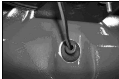
Figure. 11. Vent dans les fils laissés de lumière stroboscopique dans la cabine . Branchez le bouchon en caoutchouc , assurez-vous qu'il scelle correctement.
