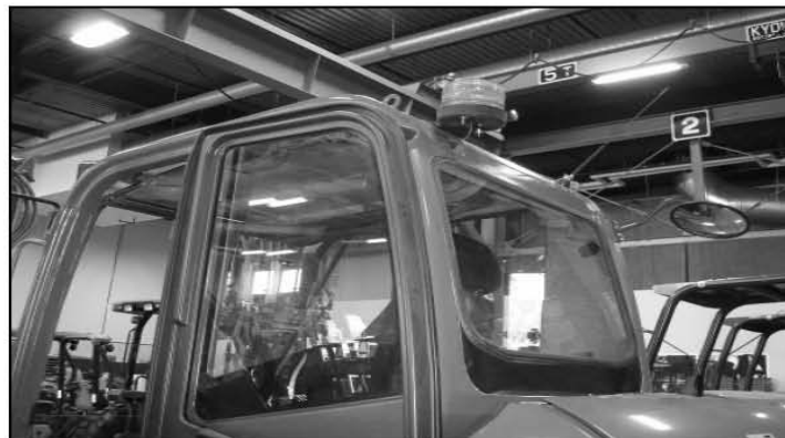
Figure. 12. Fixer la lumière stroboscopique sur le support ( support doit être fabriqué . Voir les dimensions à la page 13 )
